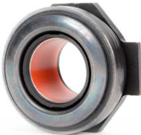
איור 3: מיסב שחרור עם שרזול מוביל המצופה טפולון - אסור לבצע גירוז
