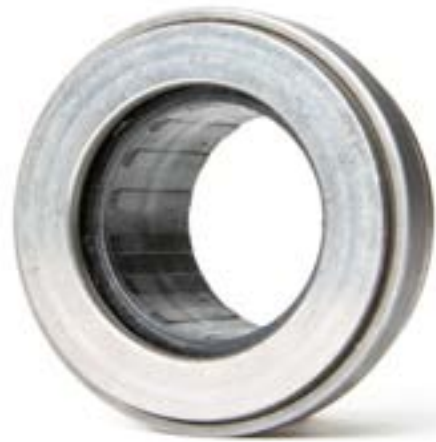
Εικόνα 2: Τα ρουλεμάν που φέρουν πλαστικό κουζινέτο ολίσθησης, δε πρέπει ποτέ να λιπαίνονται
